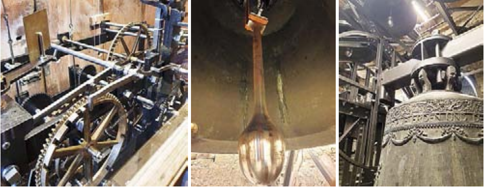
Imposantes Innenleben mit Turmuhr, Pendel und Glocken.
